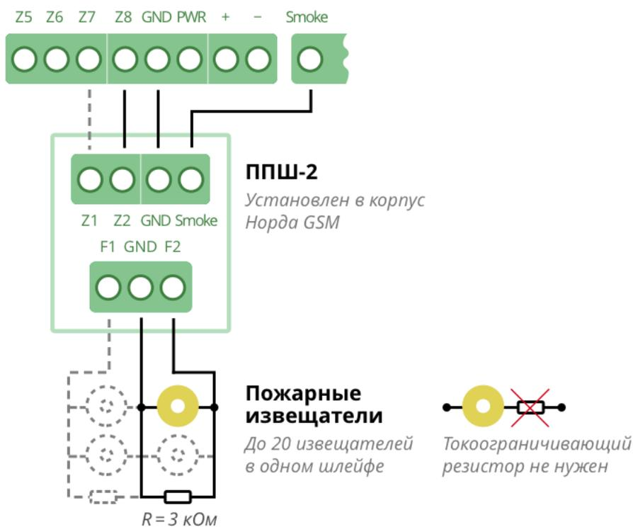
Рис. 21: Схема подключения двухпроводных дымовых пожарных извещателей через «ППШ-2»
