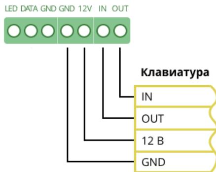
Рис. 29: Схема подключения проводных клавиатур
