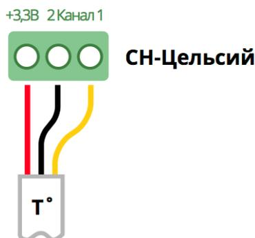
Рис. 23: Схема подключения проводного датчика температуры к СН-Цельсий
