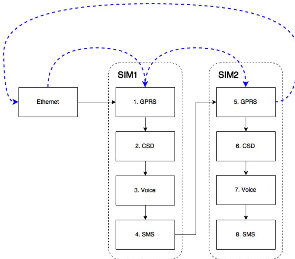
Рис. 78: Схема переключения каналов связи
