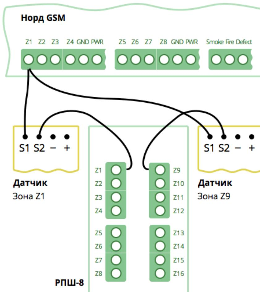
Рис. 27: Схема подключения двух шлейфов через «РПШ-8»
