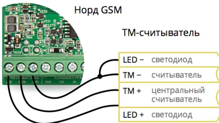
Рис. 28: Схема подключения Touch Memory считывателя
