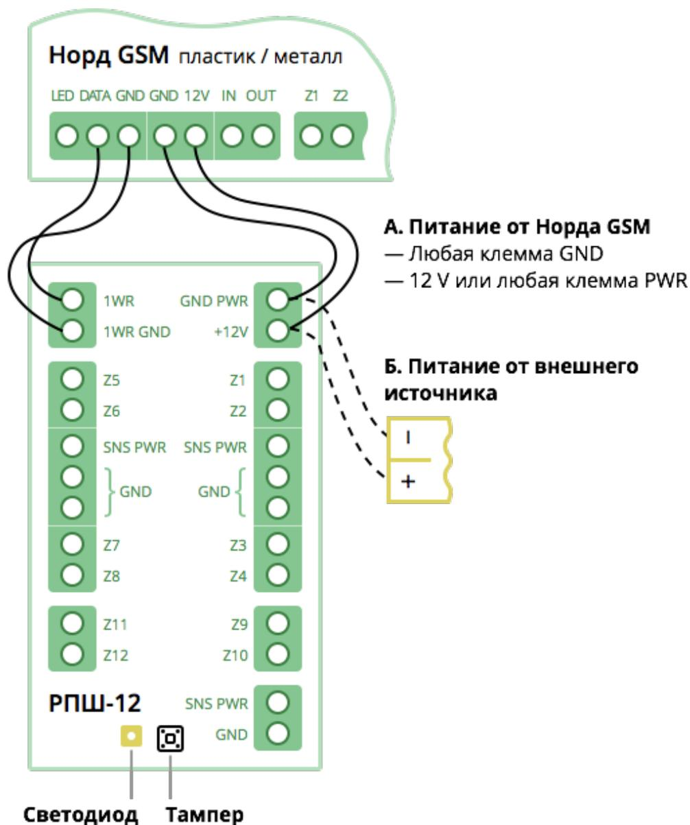
Рис. 25: Схема подключения «РПШ-12» к прибору
