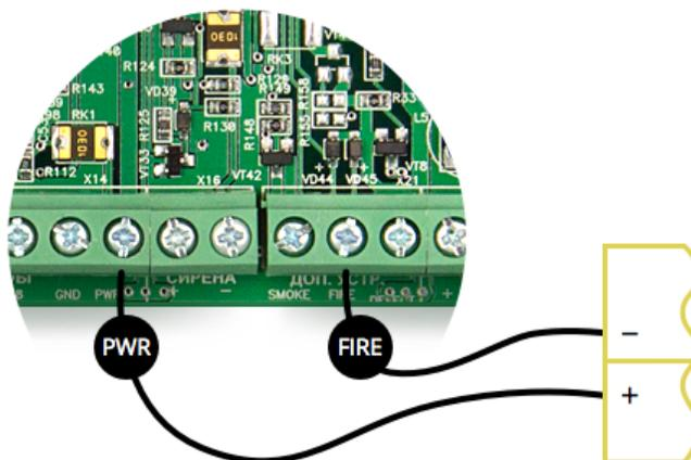
Рис. 89: Подключение светового оповещателя к прибору
