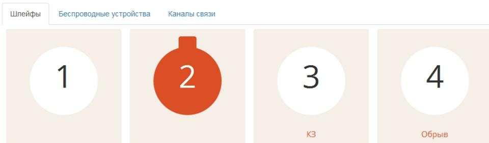
Рис. 98: Вкладка «Панель состояния», Шлейфы в состоянии: норма, тревога, короткое замыкание, обрыв
