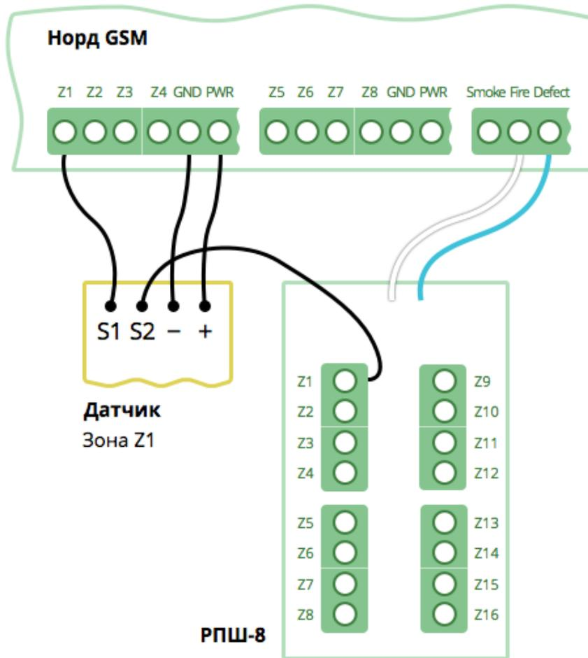
Рис. 26: Схема подключения «РПШ-8» к прибору
