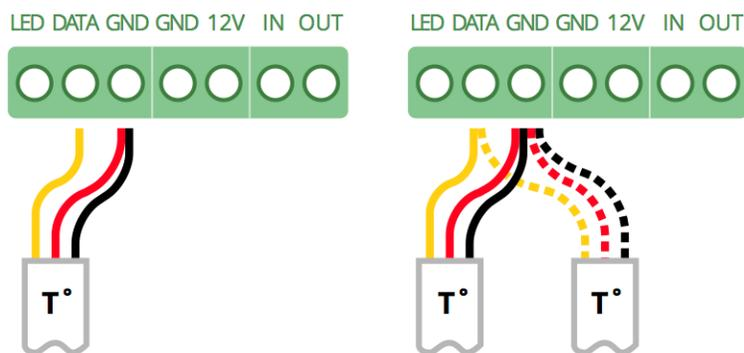
Рис. 22: Схема подключения проводного датчика температуры к прибору
